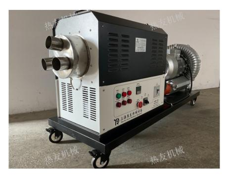
工业热风机性能: 1、工业热风机是运用纯合金材质所制作,其中不包含任何杂质,防 止长时间工作,受到空气氧化而出现烧断情况; 2、电热丝是悬挂方法安装于设备当中,并且它的结构是属于 螺旋状态,热风能够均匀散发出去,风量大并且它的风阻小,可以达到满足场所需求; 3、设备内部有保温装 置,具有防干烧的功能,从而避免设备中的电热丝干燥而损坏,影响设备的正常运行; 4、工业热风机能够长 时间的去工作,而且能够安装高温热风源,满足场所不一样的使用需求。工业暖风机的使用范围有哪些?浦东 新区工业热风机厂
